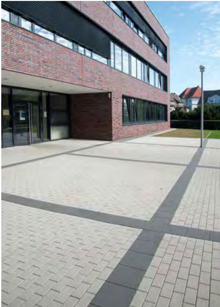
Indivo-Systempflaster mit Fase, 20×10 cm, grau Indivo-Systempflaster ohne Fase 30×30 cm, anthrazit
