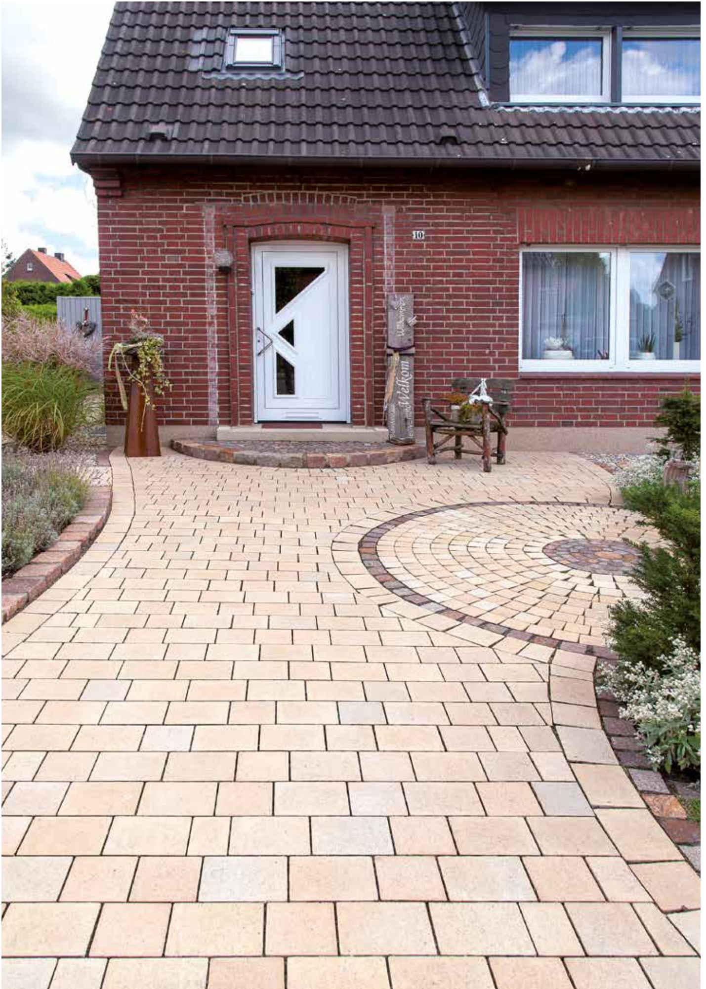
Altstadtpflaster glatt & kantig, 20×15 cm und 15×15 cm, sandsteinfarbig nuanciert – Kreisausführung mit Steingröße 10×10 cm und Naturstein
